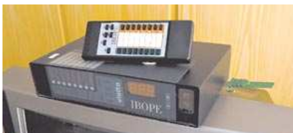
Figura 1. Audímetro people meter , com controle remoto
