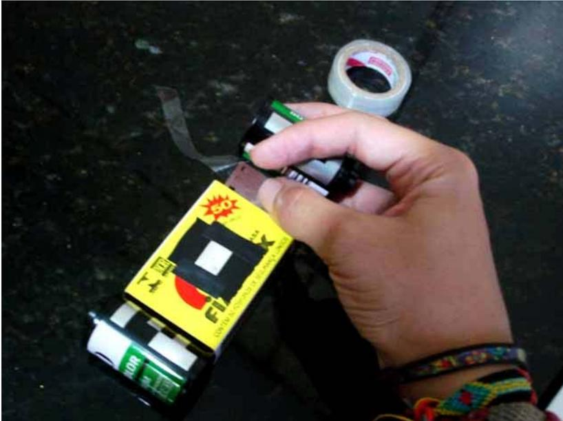
Colocar a bobina vazia do outro lado da caixa, introduzir a gaveta com o lado da janelinha cortada para trás, e colar com fita adesiva o negativo da bobina cheia com a pontinha que sobra da que está vazia.
